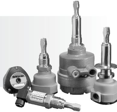
As Chaves de Nível Vibratória são ideais para detecção de líquidos. Utiliza tecnologia com cristal piezo-resistivo que vibra em uma frequência pré-definida, e é inserido dentro de um dispositivo (garfo) em forma de diapásão. Quando o garfo é encoberto por um líquido esta frequência se altera e é detectada por um circuito eletrônico que é convertido em uma saída ( Relé ou PNP/NPN) dependendo do Modelo.
