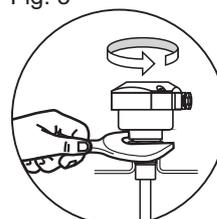
Faz-se necessária uma inspeção visual periódica da sonda para verificar se há corrosão ou acumulação de resíduos. Se forem encontrados tais depósitos, limpar a haste para assegurar um ótimo desempenho.
