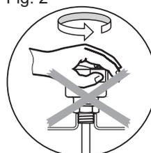
Ao apertar a sonda use a chave adequada, aperte até conseguir selar, evite segurar no cabeçote e não use o mesmo para rosquear a sonda. (Fig. 3)
