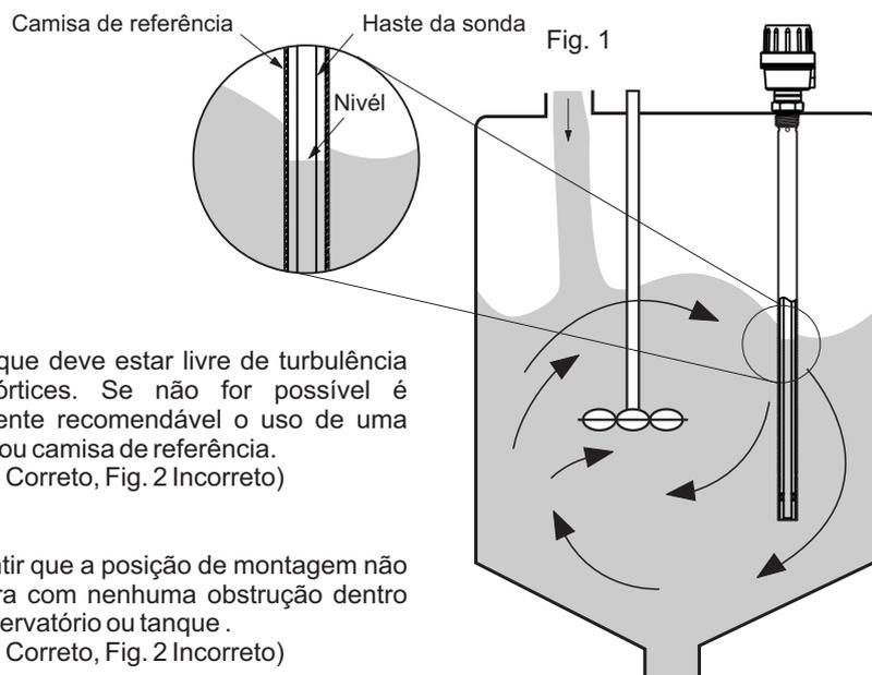
O tanque deve estar livre de turbulência ou vórtices. Se não for possível é altamente recomendável o uso de uma haste ou camisa de referência. (Fig. 1 Correto, Fig. 2 Incorreto)
