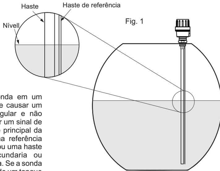
A instalação da sonda em um tanque circular pode causar um sinal de saída irregular e não linear. Para alcançar um sinal de saída linear a haste principal da sonda deve ter uma referência paralela ao tanque ou uma haste de referência secundária ou camisa de referência. Se a sonda for instalada dentro de um tanque cilíndrico sem uma referência (ao lado), o sinal de saída não será linear. Por favor consulte um de nossos engenheiros de processo se houver dúvidas (Fig.1 correta, Fig.2 incorreta)
